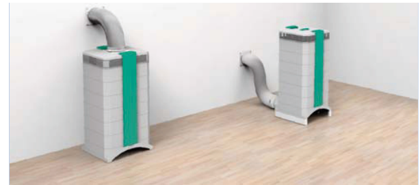
IQAir System mit OutFlow™ und InFlow™ Rohranschlüssen zur Herstellung von Über- und Unterdruckbereichen.
